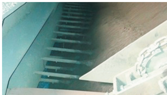
FIGURA 5. Sistema de alimentação de sínter na usina em operação com duas fileiras de barras de permeabilidade horizontais.
