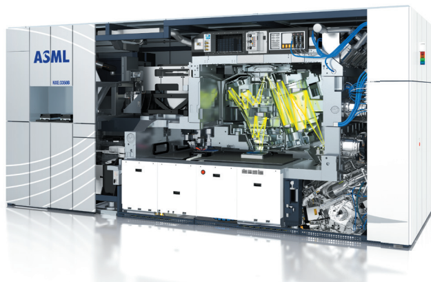
FIGURA 2. O sistema EVU pronto para produção ASML® TWINSKAN® NXE:3350B produz 125 wafers de chips por hora, utilizando luz com comprimento de onda de 13,5 nm. A máquina deve manter um vácuo perfeito enquanto move os wafers em alta velocidade e altas condições de carga, mantendo as distorções abaixo de 1 nm.
