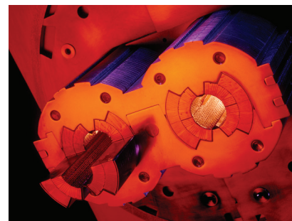
РИС. 2. Подробный вид апертуры главного дипольного магнита. Сверхпроводящие обмотки удерживаются поясами из аустенитной стали, выдерживающими электромагнитные силы величиной 2 МН/м на четверть витка обмотки при номинальном магнитном поле.
