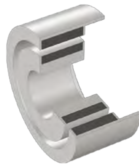
图 1. 磁力联轴器结构示意图。
