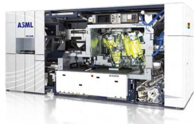
图2. ASML® TWINSCAN® NXE:3350B 型 EUV 生产系统, 采用 13.5 nm 波长的极紫外光, 每小时可制造 125 个计算机晶圆。它在高载荷下快速移动晶圆时必须维持绝对真空状态, 并确保晶圆扭曲始终小于 1 nm。
