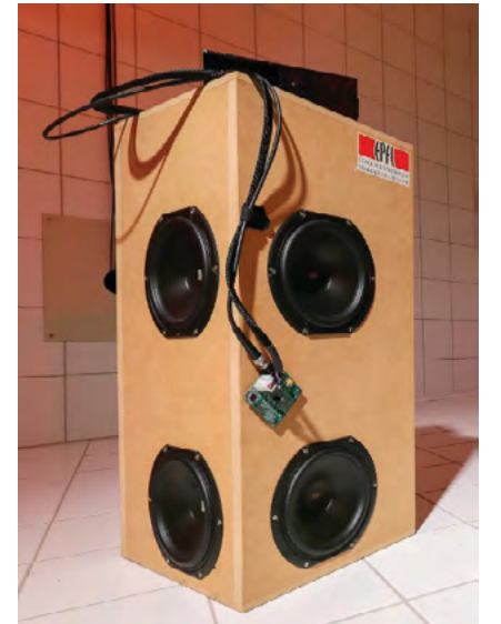
图 1. 主动式电声谐振器原型。图片来源：EPFL/Alain Herzog。
