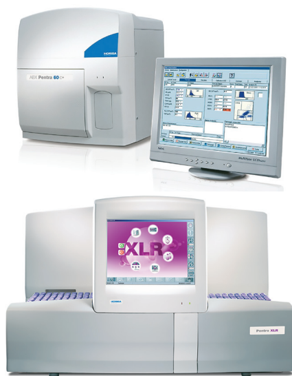
図2 Pentra シリーズの2つの血液学的検査装置である ABX Pentra 60C+ (上) と Pentra 80 XLR (下) は、マイクロ開口部電極システムを採用し、インピーダンス測定によって血液粒子の計数とサイズ分類を行います。
