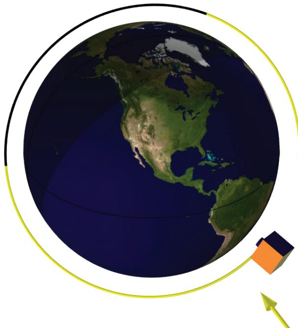
図3 軌道上の衛星の可視化。太陽および地球に対する位置と方向, および衛星の露出面への照射を示しています。地球の画像クレジット: Visible Earth および NASA。
