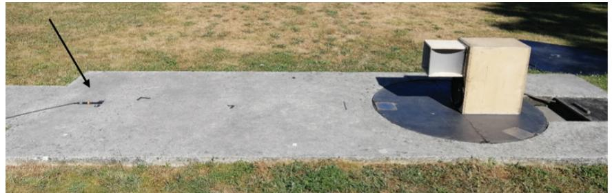
図3 一般的な音響損失測定の屋外測定セットアップ。矢印はマイクの位置を示します。
