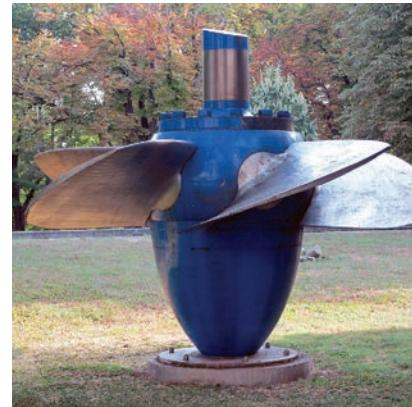
図2 カプランタービンローターの一例。画像提供: Reinraum, CC0, Wikimedia Commons.
