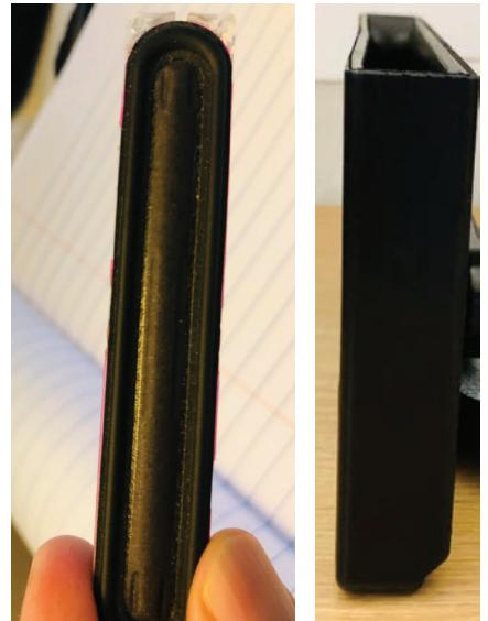
図5 極薄マイクロトランスデューサー(左)と厚さ1インチの極薄DAES(右)のプロトタイプ。
